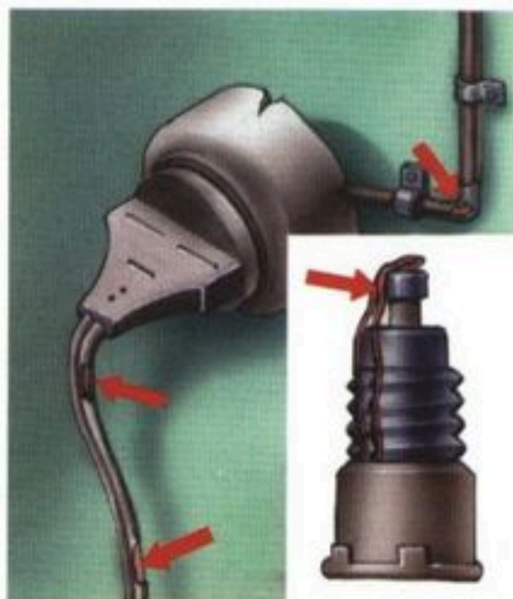
Неисправность электропроводки Пользование самодельными предохранителями
